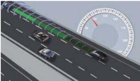
**Automatic Cruise Control (ACC)** - система автоматического круиз-контроля. Данная опция позволяет автомобилю без вмешательства водителя поддерживать заданную дистанцию до впереди идущего транспорта, при необходимости разгоняясь (но не более установленной водителем) и снижая скорость, в том числе до полной остановки, работают на радарных частотах, в частности в частотном диапазоне К (можно отметить Mercedes и BMW), так и в лазерном диапазоне (например Volvo).
