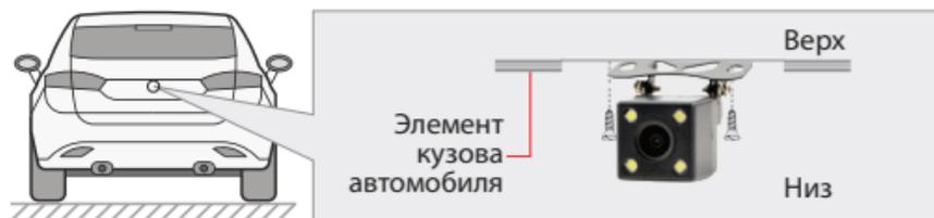
Модуль устанавливается на подиум из комплекта устройства. В комплекте имеется подиум, позволяющий установить модуль под разными углами наклона — 3, 5, и 7 градусов. Выбрать необходимый. Критерием выбора является создание оптимальной рабочей зоны камеры заднего обзора.
