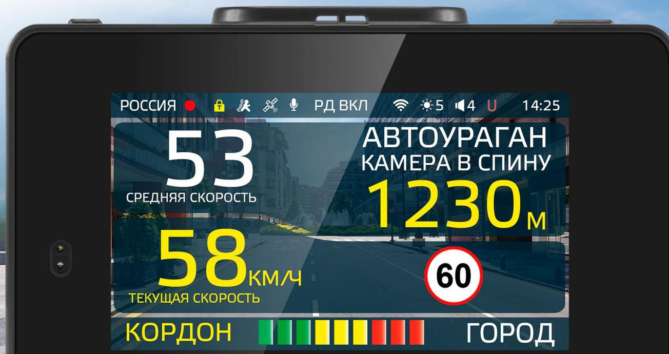
Яркий IPS дисплей высокого разрешения с диагональю 3” отлично читается под любым углом. В режиме детектирования и оповещения на дисплей выдается информация о:
