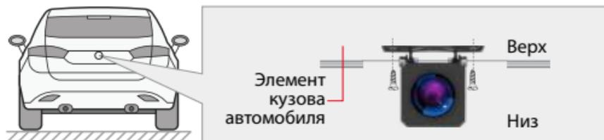
Крепление камеры заднего вида позволяет регулировать угол ее наклона. Выберите необходимый. Критерием выбора является создание оптимальной рабочей зоны камеры заднего вида.
