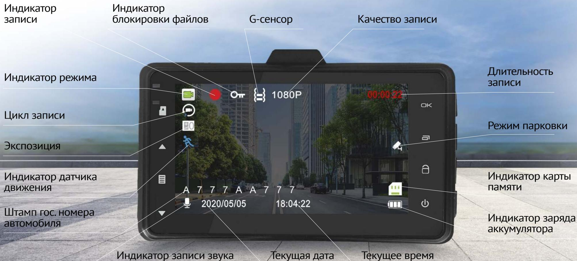
**iBOX City Dual** обладает всеми необходимыми функциями и позволяет гибко настроить их для любого пользователя. Всенеобходимые для контроля видеозаписи установки интуитивно понятно отображаются на дисплее.
