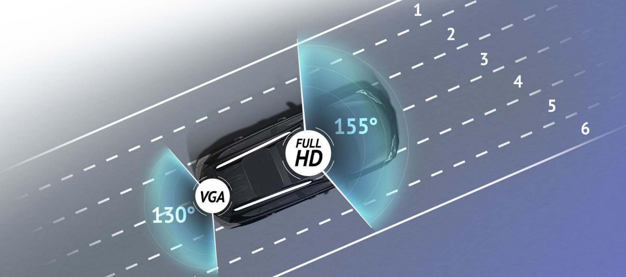
Мощный процессор **Jieli JL5212** поддерживает детализированную съемку фронтальной камеры в разрешении Full HD. При подключении второй камеры запись осуществляется в разрешении HD для фронтальной камеры и VGA для камеры заднего вида. Угол обзора фронтальной камеры составляет **155 градусов** и позволяет устройству захватить до пяти полос дорожного полотна и обочину. Камера заднего вида обладает углом обзора – **130 градусов**.
