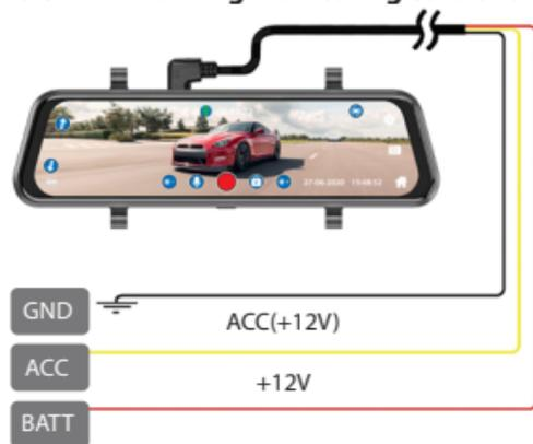
Кабель питания **iBOX 24H Parking monitoring cord S10** позволяет не допустить критической разрядки аккумулятора автомобиля. В каком бы режиме ни работал видеорегистратор, кабель автоматически отключает его питание, при падении напряжения ниже 11,8 В для аккумуляторов с напряжением 12 В и ниже 23,4 В для аккумуляторов с напряжением 24 В.
